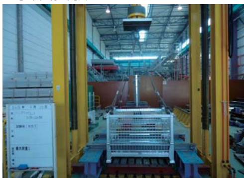
平均破壊荷重82.9kN 安全率5以上
