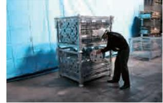
下段パレットの荷物出し入れ可能 (パネルは必ず元に戻して下さい)
