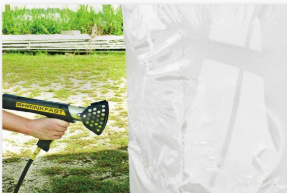
専用ヒートガンにて加熱し溶着・収縮し 張り強度のあるきれいな仕上がりに。
