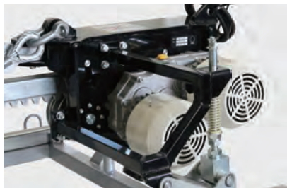
連結台車 (定速ブレーキ装置)
