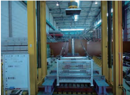
平均破壊荷重82.9KN 安全率5以上
